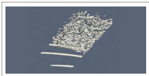
図1. 回転円板流れに生成される渦の可視化
