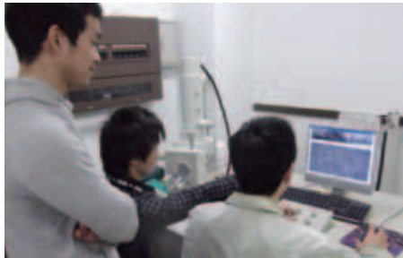
走査型電子顕微鏡による金属材料破面の観察
