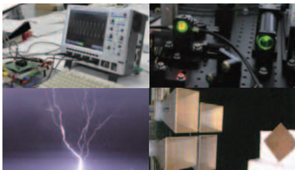
半導体集積回路の測定(左上)、フェムト秒レーザーによる測定(右上) 鉄塔に落ちる上向き雷(左下)、電波散乱の計測(右下)
