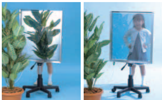
鏡の状態と透明な状態がスイッチングできる調光ミラーガラス
