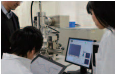
FIBIによる試料表面の微細加工
