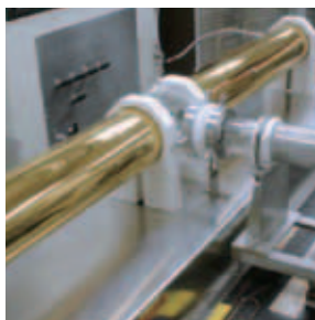
新開発のNOx除去装置
