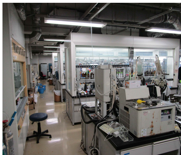
図2. 卓上フードが設置されたC棟化学系実験室
