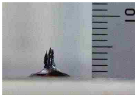
図 1 シリコン堆積物(5分での製膜結果)
