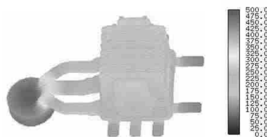
図2 離型直前の製品温度分布の計算結果
