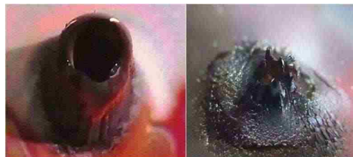
図 2 様々な形状のシリコン堆積物 (左 筒状、右 山状の堆積物)
