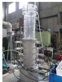
地盤に降雨浸透させる実験の様子
